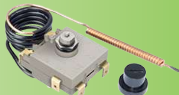
Двухполюсный термостат высокого предела с ручным сбросом, отказоустойчивый, фиксированная настройка, диапазон температур до 170°C
